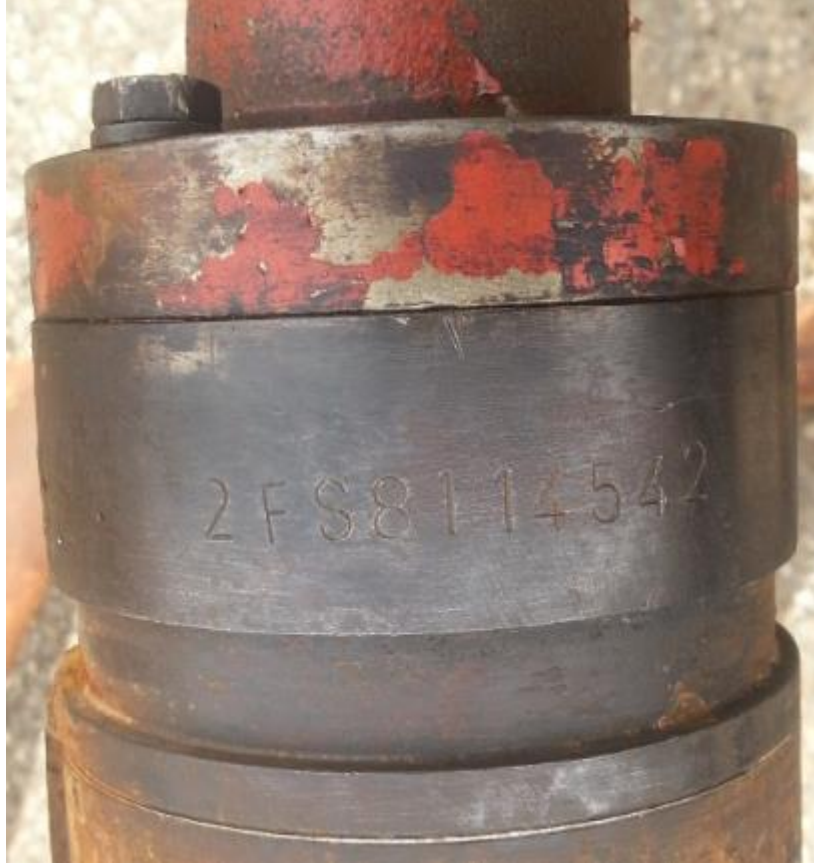
ŞEKİL-3: Örnek Gövde Üzerine Seri Numarası ve Parça Numarası Yazılması.
